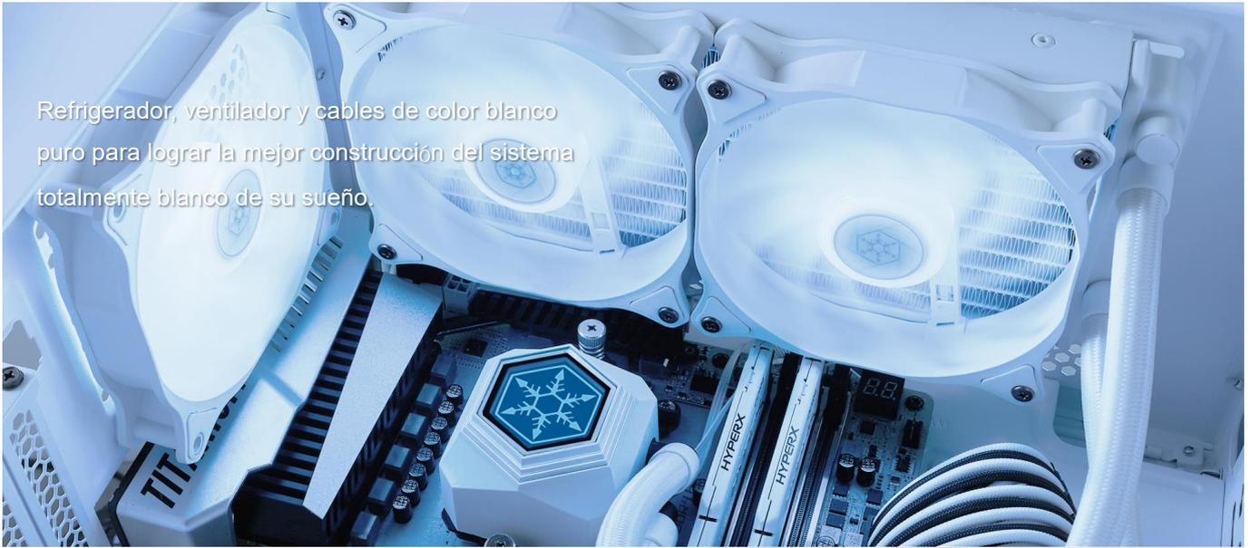
El bloque de agua incluye una bomba con diseño multi cámara que aísla los canales con líquidos calientes y fríos para evitar filtraciones de calor y que así sea más efectiva la eliminación del calor del bloque de agua.
