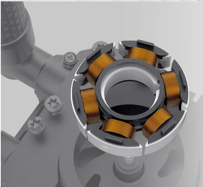
El motor de la bomba usa un diseño tres fases y seis astas para conseguir un funcionamiento más suave y silencioso si se compara con la mayoría de diseños de una fase y cuatro astas. La eficiencia energética también se mejora.
